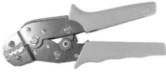
Предназначены для зажима наконечников без изоляции. Все инструменты снабжены блокировкой, которая обеспечивает повторяемость зажатия наконечников на проводе, а также механизмом компенсирующим возможный износ.
