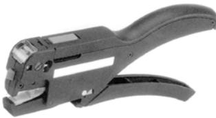
Универсальный инструмент для снятия изоляции с проводов, зажима изолированных втулочных наконечников DIN 46228 и резки проводов. Наконечники находятся в магазине в виде ленты – подаются автоматически. Изоляция снимается лобовой стороной инструмента, а зажим наконечников и отрезка проводов производится боковой стороной инструмента.
