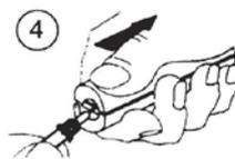
1.; 2. Снятие наружной изоляции;
