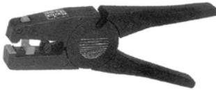
Предназначен для удаления изоляции с круглых одно и многожильных проводов, а также с плоских многожильных кабелей. Большое количество режущих лезвий обеспечивает припасовку и предотвращает жилы от механического повреждения. Снабжен упором для точной регулировки длины удаляемой изоляции и лезвиями для резки медных и алюминиевых проводов.
