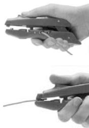
Предназначен для удаления изоляции, зажима наконечников Н и HI, а так же для резки проводов диапазоном от 0,5÷6 мм;
