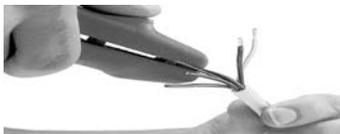
Профессиональный нож для удаления изоляции с круглых проводов диаметром 4÷28 мм и для удаления изоляции с проводов сечением от 0,5÷6 мм<sup>2</sup> (две функции в одном инструменте).
